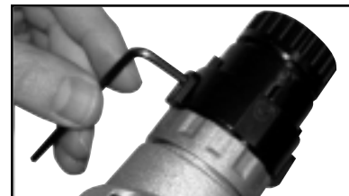
Remplacez-le par l'adaptateur approprié (serrez les vis de fixation sur les modèles DeWalt et Milwaukee)
